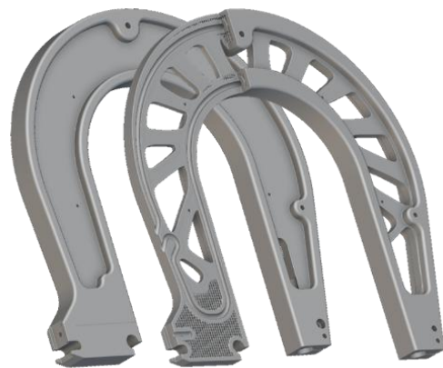
Arm einer Schweißzange: Vor und nach Umgestaltung für die additive Fertigung (Arm of a welding gun: before and after redesign for additive manufacturing).
