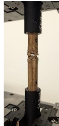
Zugprüfung der Steck- und Klebverbindung (Tensile test of the plug-in and adhesive connection).
