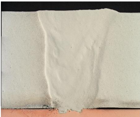
Schweißnaht einer Aluminium-Kupfer-Mischverbindung (Weld seam of an aluminum-copper-mixed joint).
