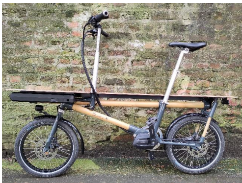
Lastenradprototyp mit Bambusrahmen (Cargo bike prototype with bamboo frame).
