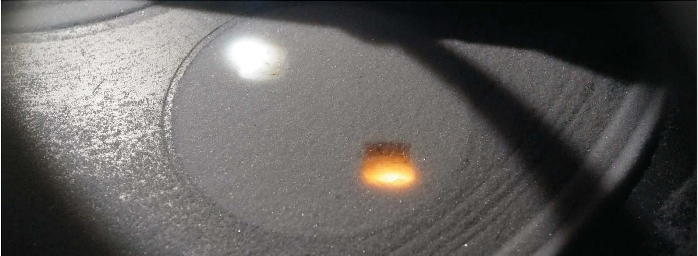
*Verarbeitung von Glaswerkstoffen mittels Laser Powder Bed Fusion.
