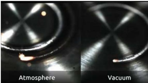
*Vergleich Schweißpunkt unter Atmosphäre und im Vakuum. (Comparison of weld spot under atmosphere and in vacuum.)*
